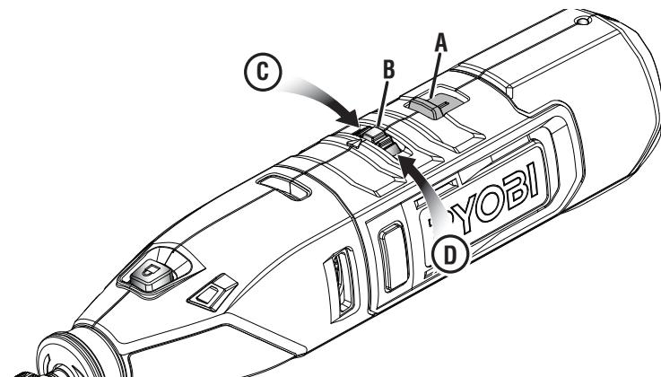
A - On/off switch (commutateur marche/arrêt, interruptor de encendido/apagado)
