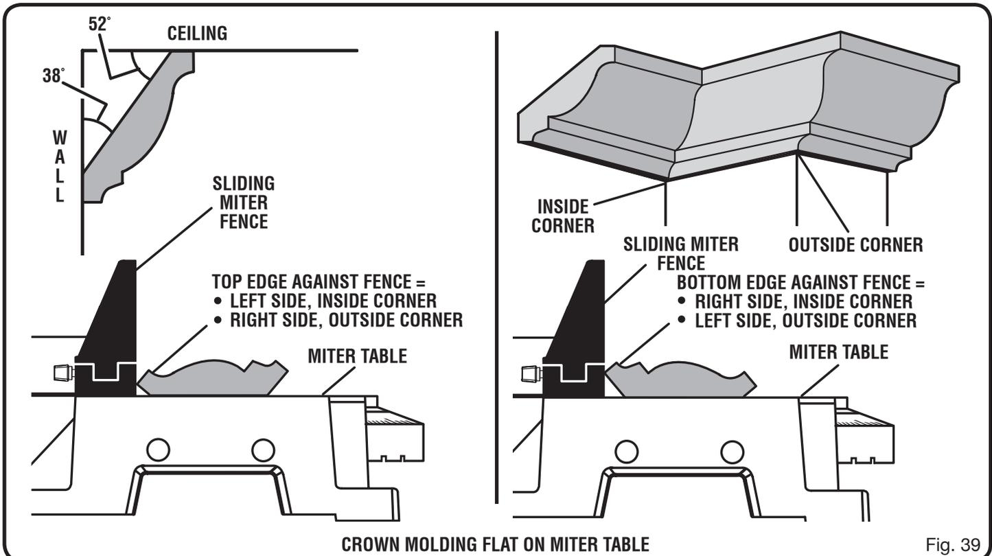
CROWN MOLDING FLAT ON MITER TABLE
