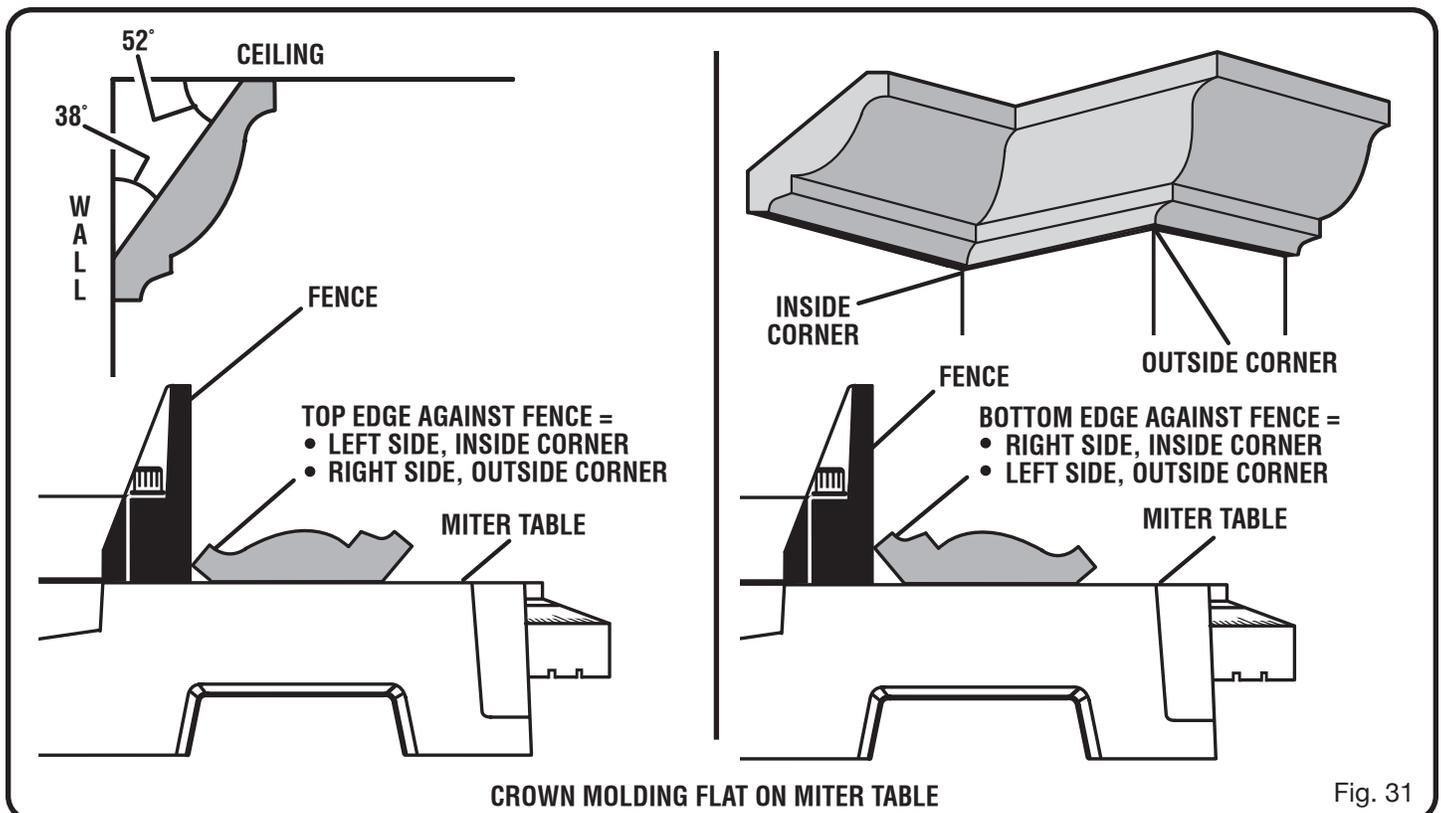
CROWN MOLDING FLAT ON MITER TABLE
