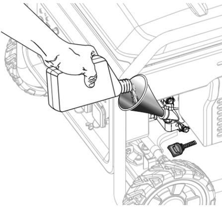
Ubique la unidad sobre una superficie plana para que el motor esté nivelado. Quite la varilla para medir el nivel de aceite, límpiela, vuelva a colocarla en el orificio (pero no la enrosque) y verifique el nivel de lubricante.
