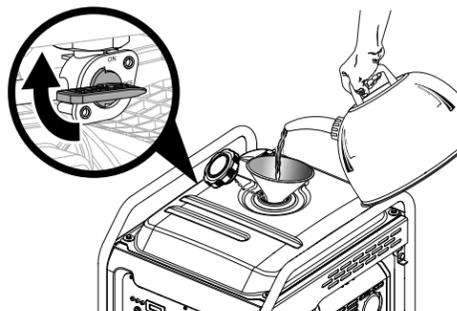
Este es un motor de cuatro tiempos. No mezcle el lubricante y el combustible.
