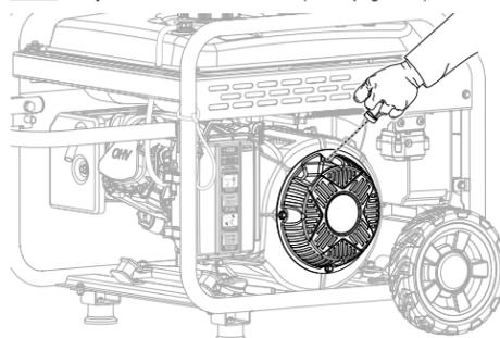
**5** Permita que el motor funcione 30 segundos y, después, coloque la palanca del anegador en la posición RUN (FUNCIONAMIENTO) (vea la página 16).
