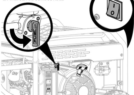
**3** Coloque la palanca del anegador en la posición START (ARRANQUE) (vea la página 16).
