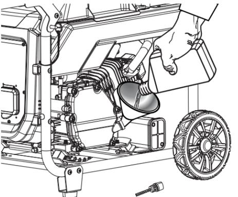
Déposer l'appareil sur une surface plane pour que le moteur soit à niveau. Retirer la jauge d'huile, l'essuyer complètement et la replonger dans l'orifice (sans toutefois la visser) et vérifier le niveau de lubrifiant.
