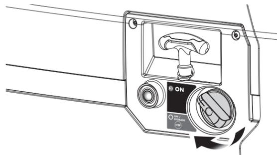
5 Pour le démarrage électrique, appuyer sur le bouton de démarrage pendant 5 secondes avant de relâcher ou tirer le lanceur à rappel pour démarrer (voir la page 17).
