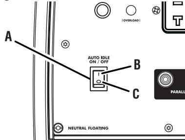
**A** - Auto idle switch (mode de marche au ralenti automatique, interruptor de ralentí automático)
