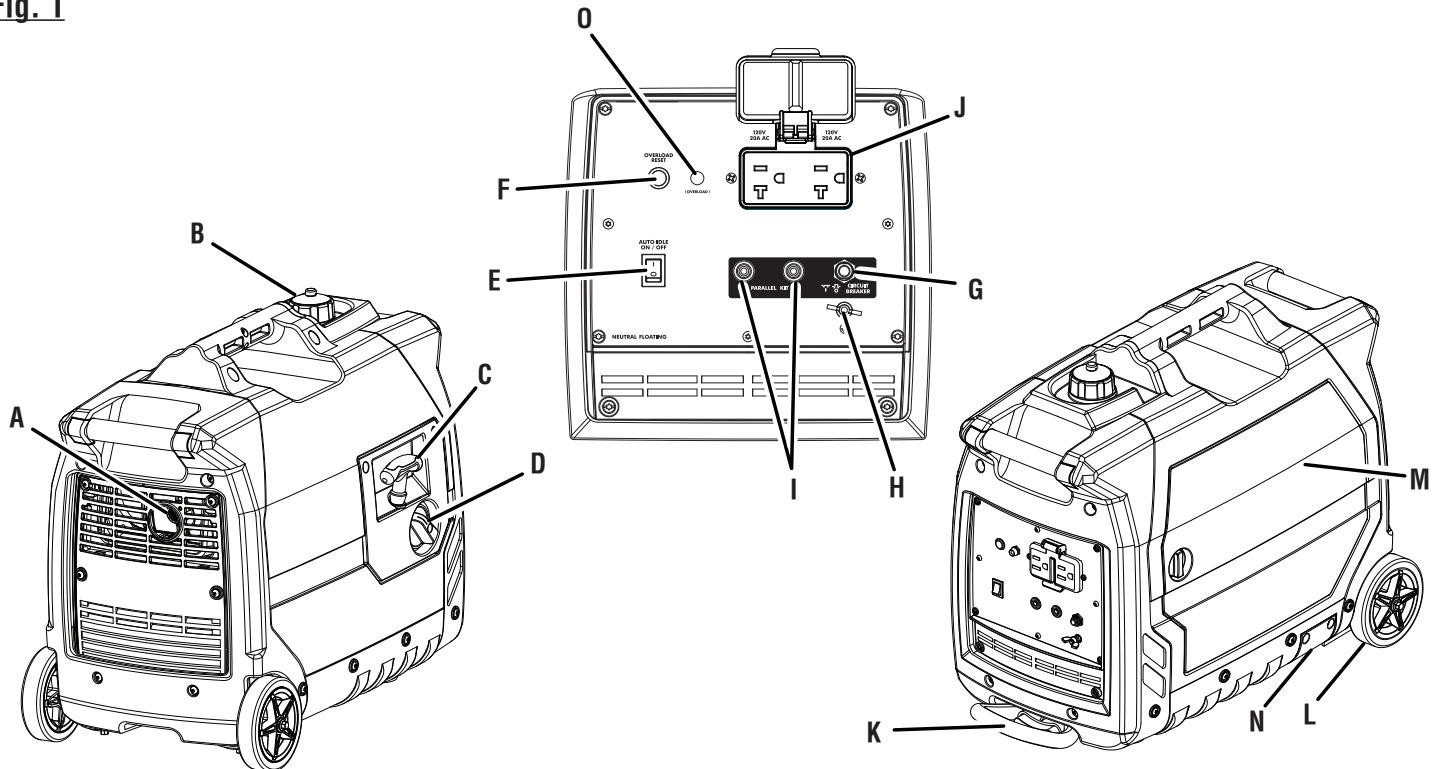
**A** - Muffler with spark arrestor screen (silencieux avec écran pare-étincelles, silenciador con pantalla parachispas)
