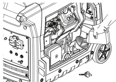
2 Déposer l'appareil sur une surface plane pour que le moteur soit à niveau. Retirer la jauge d'huile, l'essuyer complètement et la replonger dans l'orifice (sans toutefois la visser) et vérifier le niveau de lubrifiant.
