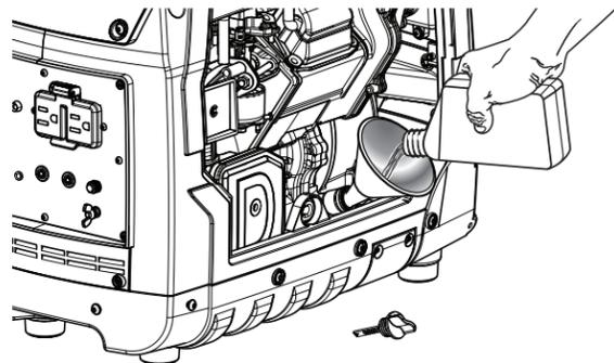
2 Déposer l'appareil sur une surface plane pour que le moteur soit à niveau. Retirer la jauge d'huile, l'essuyer complètement et la replonger dans l'orifice (sans toutefois la visser) et vérifier le niveau de lubrifiant.
