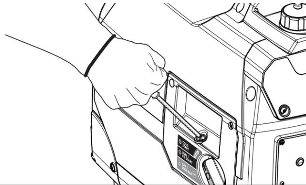
5 Laisser le moteur tourner pendant 15 - 30 secondes et mettre le cadran le Easy Start sur « RUN/RE-START » (centre) (voir page 15).
