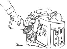
Ubique la unidad sobre una superficie plana para que el motor esté nivelado. Quite la varilla para medir el nivel de aceite, límpiela, vuelva a colocarla en el orificio (pero no la enrosque) y verifique el nivel de
