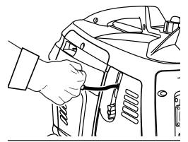
Permita que el motor funcione 15-30 segundos y, después, desplace izquierda la palanca del anegador en la posición funcionamiento (vea la página 14).
