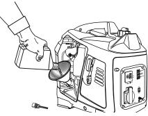
Déposer l'appareil sur une surface plane pour que le moteur soit à niveau. Retirer la jauge de lubrifiant, l'essuyer complètement et la replonger dans l'orifice (sans toutefois la visser) et vérifier le niveau de
