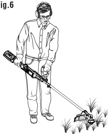
**PROPER OPERATING POSITION / BONNE POSITION DE TRAVAIL / POSICIÓN CORRECTA PARA EL MANEJO DE LA HERRAMIENTA**
