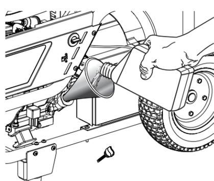
Ubique la unidad sobre una superficie plana para que el motor esté nivelado. Quite la varilla para medir el nivel de aceite, límpiela, vuelva a colocarla en el orificio (pero no la enrosque) y verifique el nivel de lubricante.
