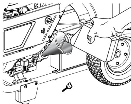
Déposer l'appareil sur une surface plane pour que le moteur soit à niveau. Retirer la jauge d'huile, l'essuyer complètement et la replonger dans l'orifice (sans toutefois la visser) et vérifier le niveau de lubrifiant.
