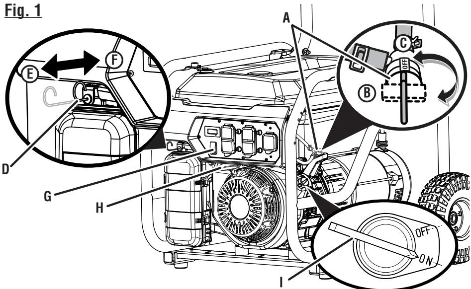
A - Fuel valve (robinet de carburant, válvula de combustible)
