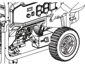
Déposer l'appareil sur une surface plane pour que le moteur soit à niveau. Retirer la jauge d'huile, l'essuyer complètement et la replonger dans l'orifice (sans toutefois la visser) et vérifier le niveau de lubrifiant.
