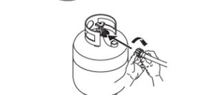
**8** Essai d'étanchéité des vannes, du tuyau et du régulateur (voir la page 17).
