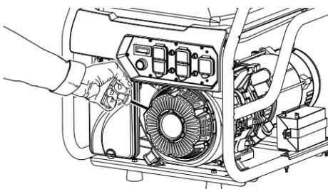
4 Laisser le moteur tourner pendant 15-30 secondes et mettre l'interrupteur du moteur / robinet de carburant / levier d'étrangleur en position « RUN » (MARCHÉ) (voir la page 15).
