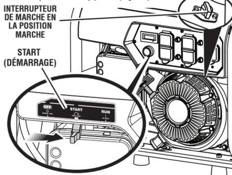
3 Appuyer sur le bouton de démarrage pour démarrer le moteur. Le moteur peut également être démarré en tirant la poignée de démarrage à rappel jusqu'à ce que le moteur démarre (voir la page 15)
