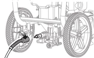
Desenrolle y enderece completamente la manguera de alta presión para evitar la formación de acodaduras.
