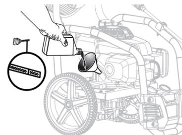
Gire la válvula de combustible a APAGADO antes de agregar aceite.
