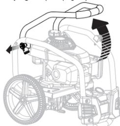
2 Installation du support de la poignée à gâchette, du support de la lance d'arrosage, et du compartiment de rangement du tuyau flexible (voir page 8).
