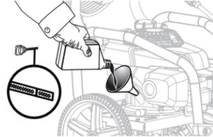
Gire la válvula de combustible a APAGADO antes de agregar aceite.
