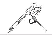
Raccordement du tuyau haute pression à la pompe
