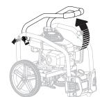
Installation du support de la poignée à gâchette, du support de la lance d'arrosage, et du compartiment de rangement du tuyau flexible (voir page 7).
