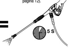
El uso de la boquilla para jabón activará el inyector de jabón con una razón de dilución de 20:1.
