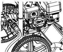
Desenrolle y enderece completamente la manguera de alta presión para evitar la formación de acodaduras.
