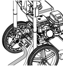
Desenrolle completamente la manguera de jardín o quítela completamente del carrete para evitar la formación de acodaduras.
