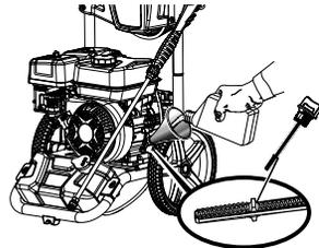
Gire la válvula de combustible a APAGADO antes de agregar aceite.
