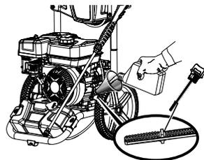
Tourner le robinet à essence à OFF (fermé) avant d'ajouter le lubrifiant.
