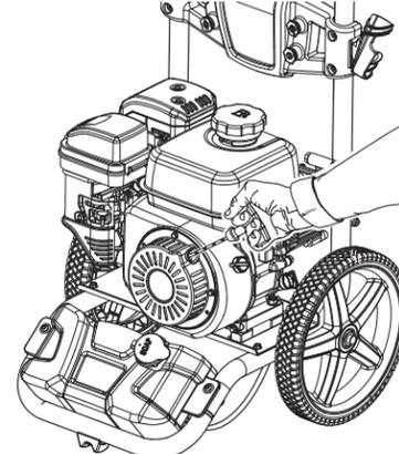
6 Laisser fonctionner le moteur pendant quelques secondes puis déplacer volet de départ à la position OFF (démarrage) (voir page 11).
