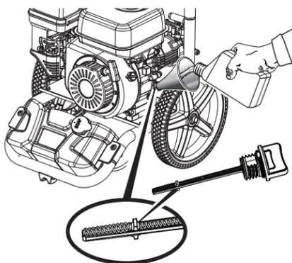
Tourner le robinet à essence à OFF (fermé) avant d'ajouter le lubrifiant.
