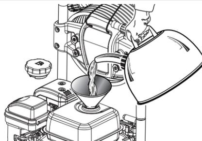
Ce moteur est un moteur 4 temps. Ne pas mélanger d'essence et de lubrifiant ensemble.
