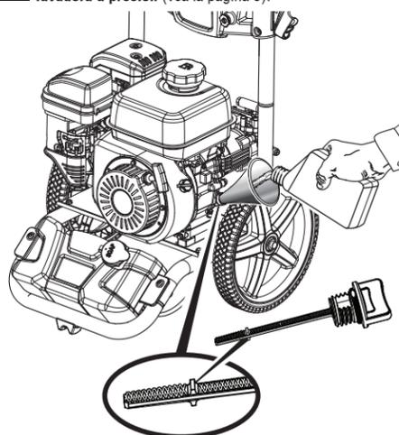
Gire la válvula de combustible a APAGADO antes de agregar lubricante.
