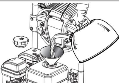
Este es un motor de cuatro tiempos. No mezcle el lubricante y el combustible.
