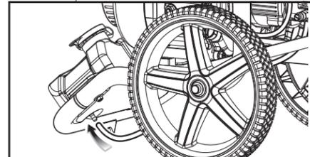
Si la manguera de inyección de jabón se afloja de la lavadora a presión, vuelva a conectarla aquí.
