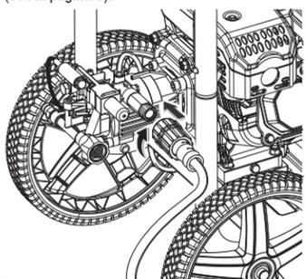
Desenrolle y enderece completamente la manguera de alta presión para evitar la formación de acodaduras.
