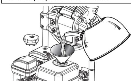
Ce moteur est un moteur 4 temps. Ne pas mélanger d'essence et de lubrifiant ensemble.
