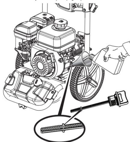
Tourner le robinet à essence à OFF (fermé) avant d'ajouter le lubrifiant.
