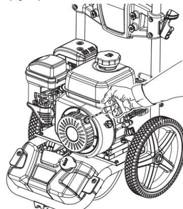
6 Laisser fonctionner le moteur pendant quelques secondes puis déplacer l'étrangleur à la position OFF (démarrage) (voir page 11).
