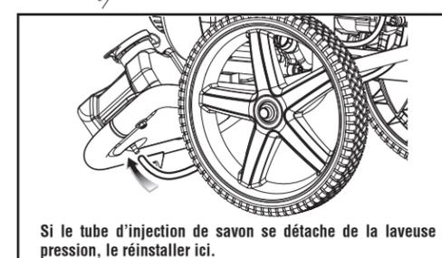
Si le tube d'injection de savon se détache de la laveuse à pression, le réinstaller ici.
