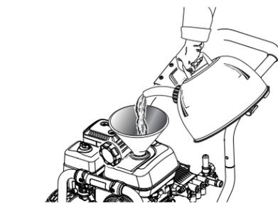
Este es un motor de cuatro tiempos. No mezcle el lubricante y el combustible.
