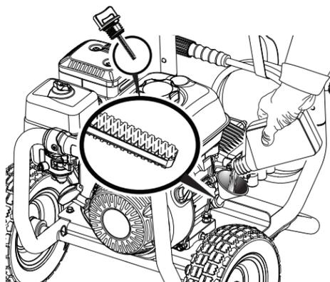
Gire la válvula de combustible a APAGADO antes de agregar lubricante.
