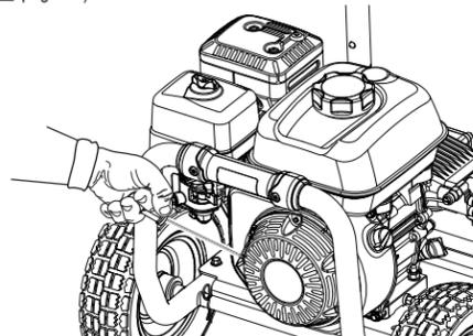
7 Laisser fonctionner le moteur pendant quelques secondes puis déplacer l'étrangleur à la position OFF (démarrage) (voir page 10).
