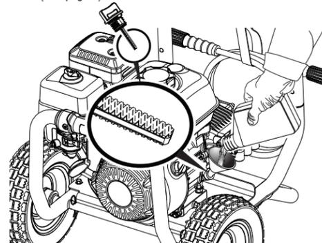
Tourner le robinet à essence à OFF (fermé) avant d'ajouter le lubrifiant.
