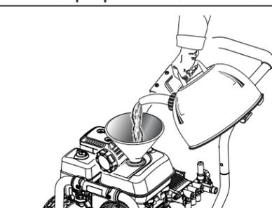
Ce moteur est un moteur 4 temps. Ne pas mélanger d'essence et de lubrifiant ensemble.
