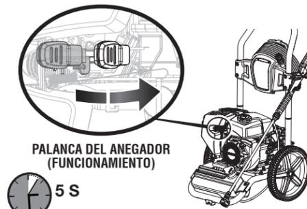
6 Mueva la palanca del anegador completamente a la derecha para detener, a continuación apague la válvula de combustible (vea la página 11).
