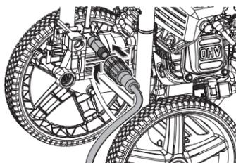
Desenrolle y enderece completamente la manguera de alta presión para evitar la formación de acodaduras.
