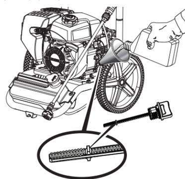
Gire la válvula de combustible a APAGADO antes de agregar aceite.
