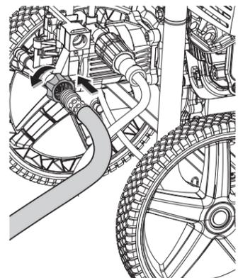
Desenrolle completamente la manguera de jardín o quítela completamente del carrete para evitar la formación de acodaduras.
