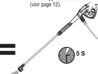
L'utilisation de la buse à savon activera l'injecteur de savon avec une quantité de dilution de 20 pour 1. **AVERTISSEMENT !** Ne jamais utiliser de javellisant ou de détergent à base de solvant.
