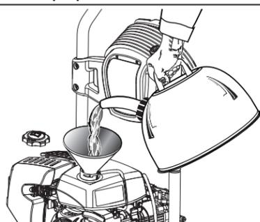
Ce moteur est un moteur 4 temps. Ne pas mélanger d'essence et de lubrifiant ensemble.
