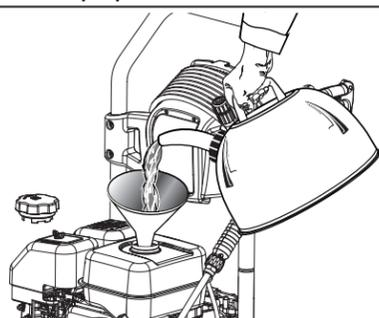
Ce moteur est un moteur 4 temps. Ne pas mélanger d'essence et de lubrifiant ensemble.
