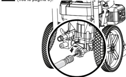
Desenrolle completamente la manguera de jardín o quítela completamente del carrete para evitar la formación de acodaduras.
