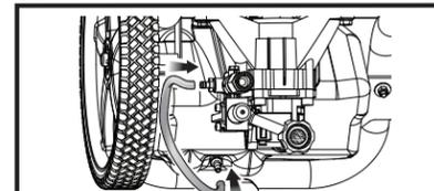
Si la manguera de inyección de jabón se afloja de la lavadora a presión, vuelva a conectarla aquí.
