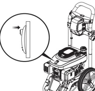
5 Deslice el botón del seguro abajo y presione el interruptor del motor en la posición ARRANQUE. El motor también puede arrancar tirando del mango del arrancador retráctil hasta que comience a funcionar el motor (vea la página 12).
