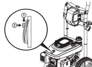
DESPLACE EL BOTÓN DE SEGURO Y PRESIONE DEL INTERRUPTOR DEL MOTOR PARA QUE ARRANQUE
