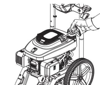
Si el motor no arranca luego de cada tirón del mango del arrancador y cuerda o una vez que el interruptor del motor se mueva a la posición ARRANQUE, oprima el gatillo para liberar la presión del agua antes de volver a intentar arrancar el motor.
