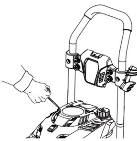
Si le moteur ne démarre pas après chaque tentative du lanceur de rappel ou pousser l'interrupteur du moteur à la position START (démarrage), appuyer sur la gâchette pour libérer la pression d'eau avant de tenter de redémarrer.
