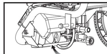
Si le tube d'injection de détergent se détache de la laveuse à pression, le réinstaller ici.
