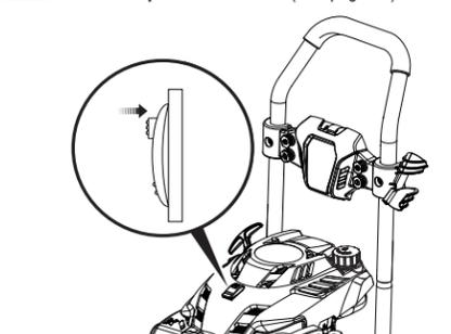
5 Glisser le bouton de verrouillage vers le bas et maintenir le bouton tout en poussant le commutateur du moteur à la position OUVERT. Le moteur peut également être démarré en tirant la poignée de démarrage à rappel jusqu'à ce que le moteur démarre. (Voir page 11).
