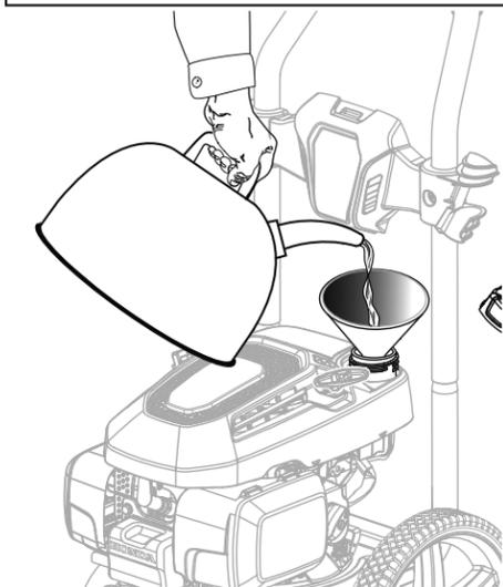
Este es un motor de cuatro tiempos. No mezcle el lubricante y el combustible.
