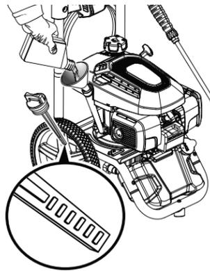
Gire la válvula de combustible a APAGADO antes de agregar lubricante.
