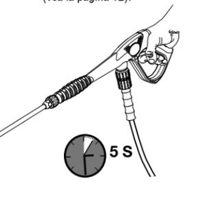
El uso de la boquilla para jabón activará el inyector de jabón con una razón de dilución de 20:1.
