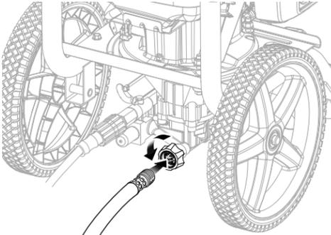
Desenrolle completamente la manguera de jardín o quítela completamente del carrete para evitar la formación de acodaduras.
