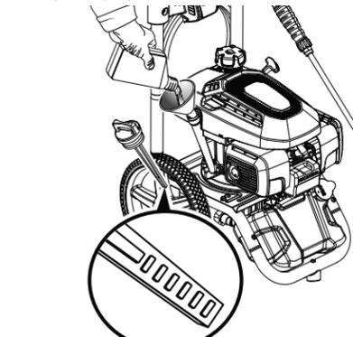
Tourner le robinet à essence à OFF (fermé) avant d'ajouter le lubrifiant.
