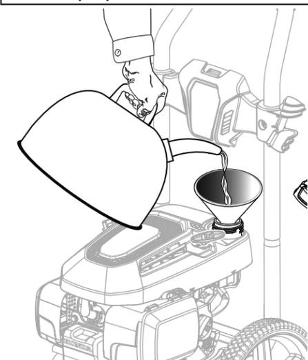
Ce moteur est un moteur 4 temps. Ne pas mélanger d'essence et de lubrifiant ensemble.
