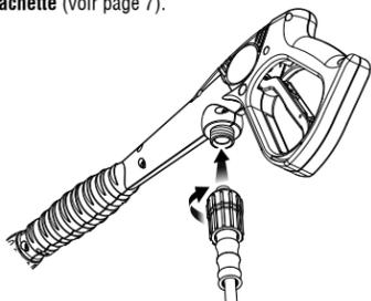
4 Raccordement du tuyau haute pression à la pompe (voir page 7).
