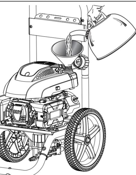
Ce moteur est un moteur 4 temps. Ne pas mélanger d'essence et de lubrifiant ensemble.
