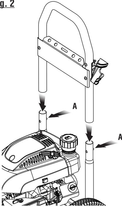
A - Push to insert (pousser pour insérer, presione para insertar)
