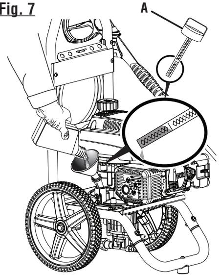
A - Oil cap/dipstick (bouchon / jauge d'huile, tapa del aceite con varilla de nivel)
