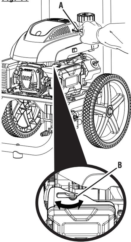
A - Starter grip and rope (poignée du lanceur et corde, mango del arrancador y cuerda)
