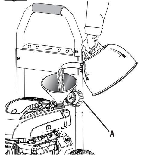
A - Fuel cap (bouchon du réservoir, tapa del tanque de combustible)
