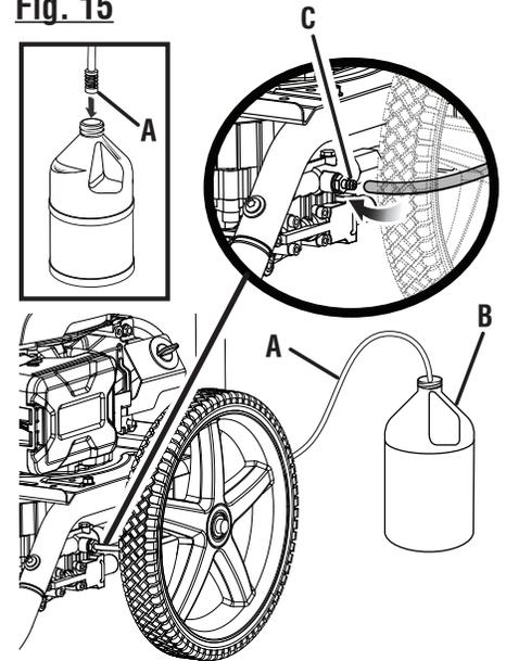
A - Soap injection hose with filter (tuyau pour l'injection du savon avec filtre, manguera de inyección del jabón con filtro)
