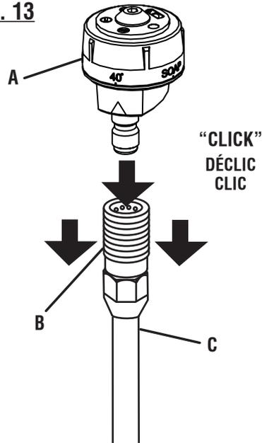
A - 5-in-1 Change-over nozzle (buse à permutation 5 en 1, boquilla intercambiable 5 en 1)
