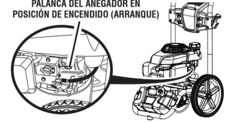
PALANCA DEL ANEGADOR EN POSICIÓN DE ENCENDIDO (ARRANQUE)
