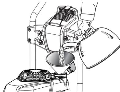
Este es un motor de cuatro tiempos. No mezcle el lubricante y el combustible.
