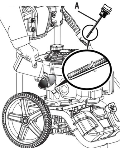
Gire la válvula de combustible a APAGADO antes de agregar aceite.
