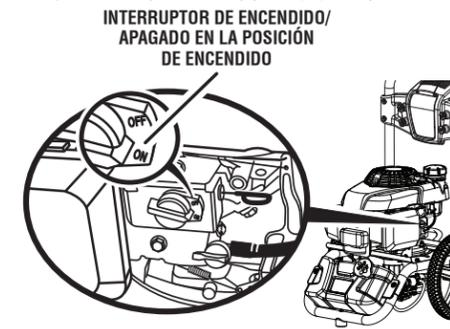
INTERRUPTOR DE ENCENDIDO/APAGADO EN LA POSICIÓN DE ENCENDIDO
