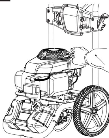
6 Laisser fonctionner le moteur pendant quelques secondes puis déplacer l'étrangleur à la position OFF (démarrage) (voir page 10).
