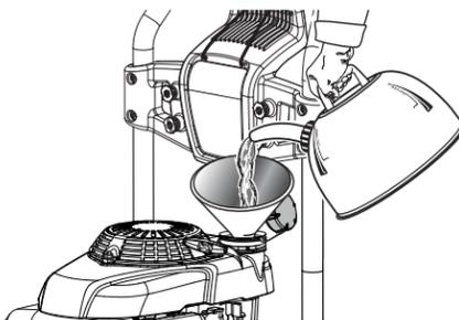
Ce moteur est un moteur 4 temps. Ne pas mélanger d'essence et d'lubrifiant ensemble.
