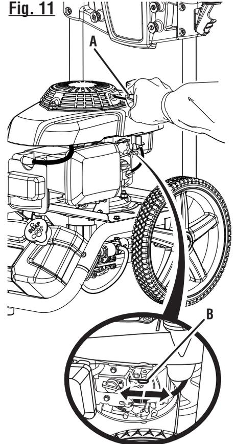
A - Starter grip and rope (poignée du lanceur et corde, mango del arrancador y cuerda)
