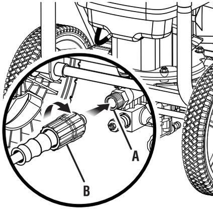
A - Threaded outlet (raccord fileté, salida con rosca)
