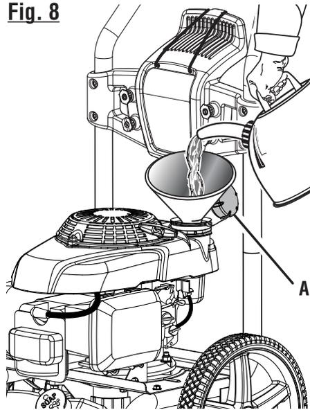
A - Fuel cap (bouchon du réservoir, tapa del tanque de combustible)
