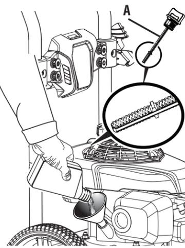
Gire la válvula de combustible a APAGADO antes de agregar lubricante.
