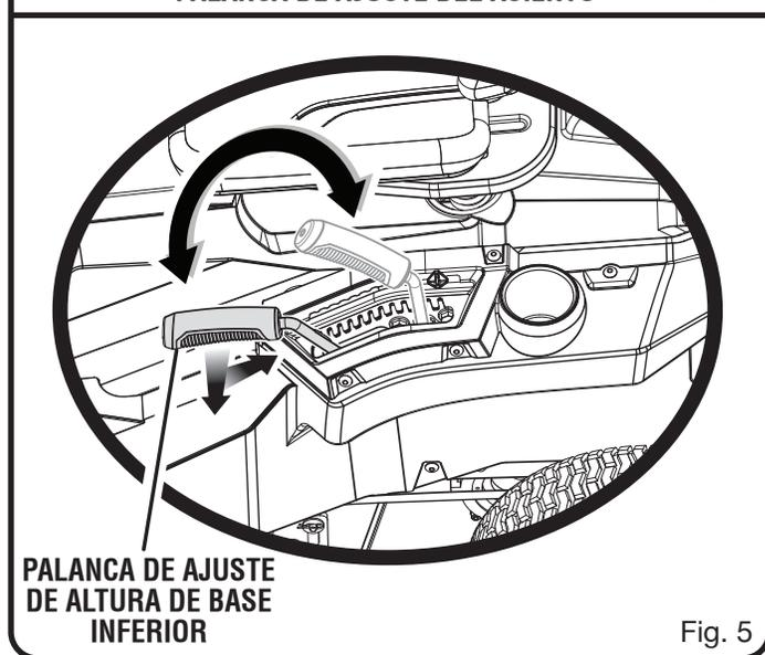
PALANCA DE AJUSTE DE ALTURA DE BASE INFERIOR
