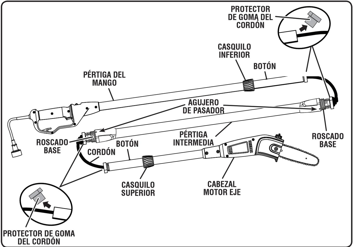
Estas instrucciones reemplazan las instrucciones para **Cómo acoplar el mango** en la página 11 del manual del operador y la figura arriba reemplazan figura 3 en las ilustraciones.
