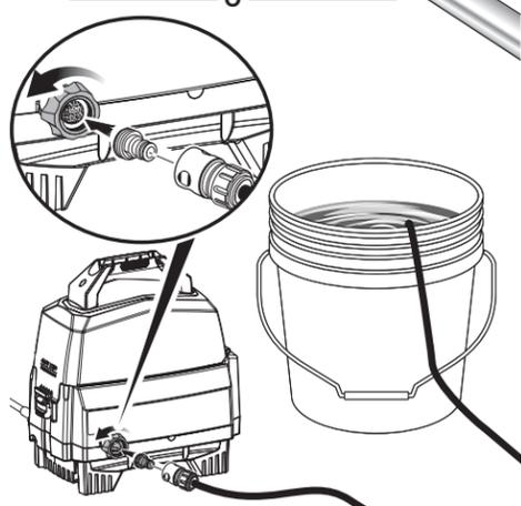
Desenrolle completamente la manguera de jardín o quítela completamente del carrete para evitar la formación de acodaduras.
