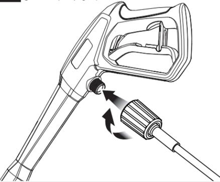
4 Connexion du flexible haute pression sur la pompe. Si vous devez vous raccorder à une source d'eau non pressurisée, installer l'adaptateur auto-amorçant. (voir page 8).
