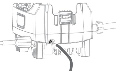
2 Verser le détergeant du nettoyeur à pression dans le seau. Connecter le tuyau d'aspiration de savon au tuyau, puis placer dans le seau. (voir page 11).
