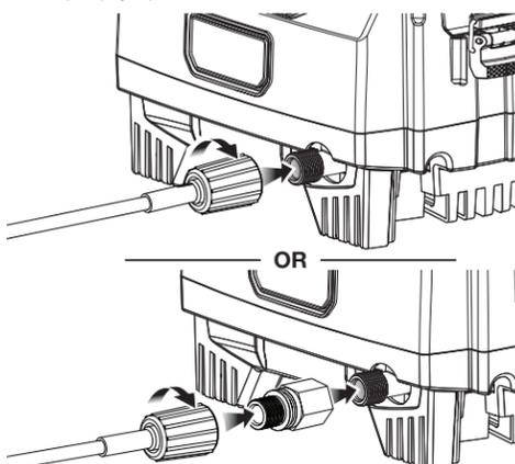
5 Connexion du tuyau d'arrosage ou tuyau à siphon au laveuse à pression (voir page 8).
