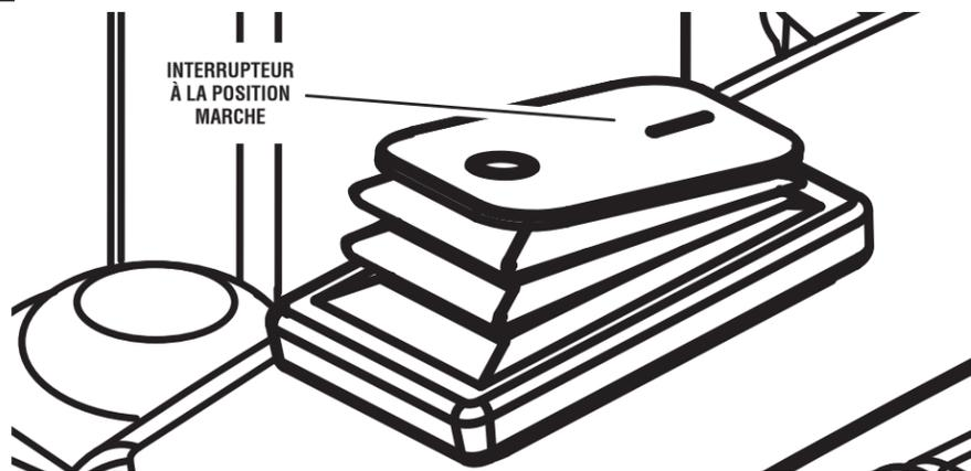
**3** Une fois fini, mettre l'interrupteur à la position OFF (0) (arrêt) pour arrêter le moteur (voir page 9).
