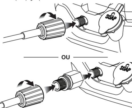
**6** Connexion du tuyau d'arrosage ou tuyau à siphon au laveuse à pression (voir page 8).
