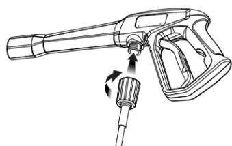
**5** Connexion du flexible haute pression sur la pompe. Si vous devez vous raccorder à une source d'eau non pressurisée, installer l'adaptateur auto-amorçant. (voir page 8).
