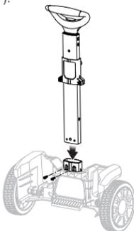
**2** Installation de l'ensemble poignée et roue sur le nettoyeur à pression (voir page 7).
