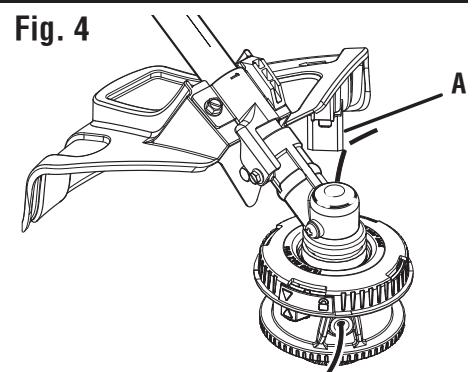
A - Line cut-off blade (lame coupe-ligne, cuchilla de corte)
