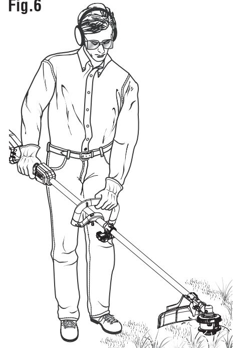
**PROPER OPERATING POSITION / BONNE POSITION DE TRAVAIL / POSICIÓN CORRECTA PARA EL MANEJO DE LA HERRAMIENTA**
