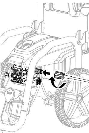
Desenrolle completamente la manguera de jardín o quítela completamente del carrete para evitar la formación de acodaduras.
