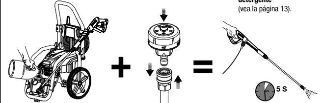
El uso de la boquilla para jabón activará el inyector de jabón con una razón de dilución de 20:1.
