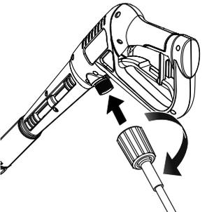
**5** Connexion du tuyau d'arrosage au nettoyeur haute pression (voir page 9).
