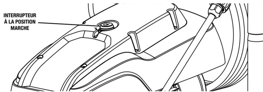
3 Une fois fini, mettre l'interrupteur à la position OFF (0) (arrêt) pour arrêter le moteur (voir page 11).
