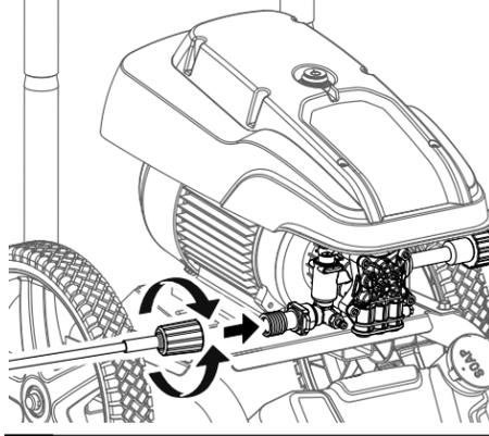
7 Connexion du tuyau d'arrosage au nettoyeur haute pression (voir page 9).
