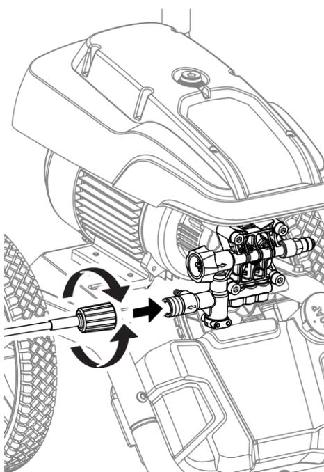
**5** Connexion du tuyau d'arrosage au nettoyeur haute pression (voir page 9).
